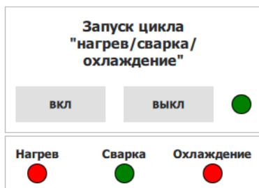
Рисунок 3 - Панель управления автоматическим режимом (Запущен цикл "нагрев/сварка/охлаждение", этап «Сварка»)
